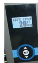
Ручное управление (стандарт) Имеет таймер времени расстойки (по окончании раздаёт звуковой сигнал)
