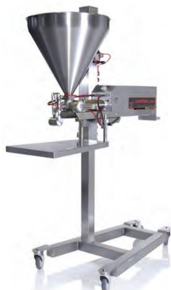
**Дозатор серии Universal 1000i** – это наиболее гибкая система порционирования, может использоваться для быстрого дозирования масел, наполнителей, соусов и даже нежных муссов. Возможно оснащение большим числом различных насадок, включая дозирующие головки и ручные насадки, а также эргономичную систему наполнения бункера.
